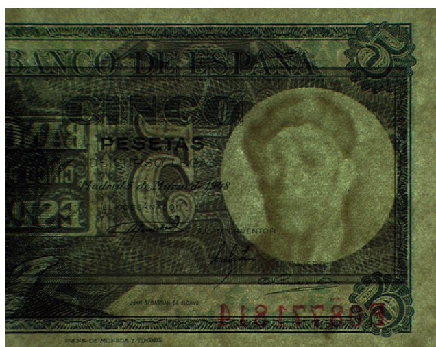
Ilustración 48: Imagen de la marca de agua del anverso realizada con luz transmitida.
