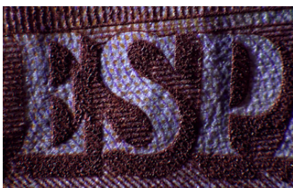
Ilustración 16: Detalle en el anverso de la palabra «ESPAÑA», donde se observa el relieve calcográfico en negativo.
