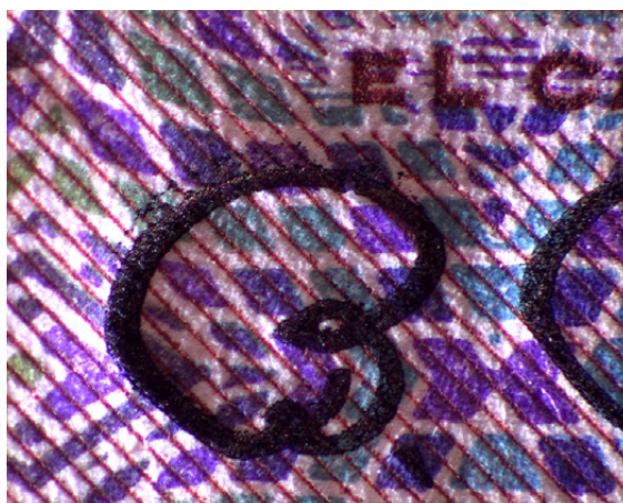
Ilustración 20: Detalle en el anverso de la firma del cajero, Bonifacio Burgos Delgado. Se puede apreciar el relieve en tinta negra y algunas manchas que provocan los tipos al realizar su impresión en el sustrato.
