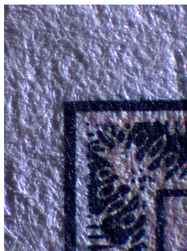
Ilustración 47: Detalle del sustrato en el anverso en el que se pueden apreciar las fibras de algodón con las que está fabricado. La imagen corresponde a la zona superior izquierda.
