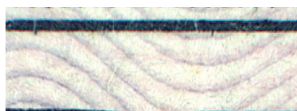
Ilustración 53: Detalle del margen superior del anverso del billete en el que se aprecia el efecto irisado y la transición de color en la estructura de líneas especiales onduladas.
