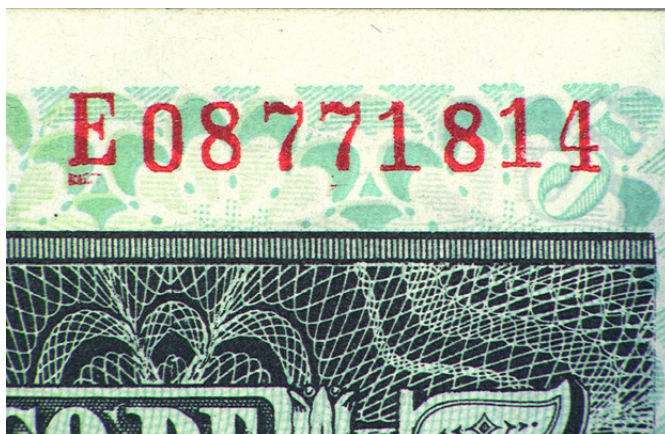
Ilustración 45: Detalle del margen superior derecho del reverso del billete en el que se muestra el número de serie impreso en tinta roja con técnica tipográfica. Como es apreciable, se pueden encontrar manchas provocadas por la impronta de los tipos sobre el sustrato alrededor de la impresión.
