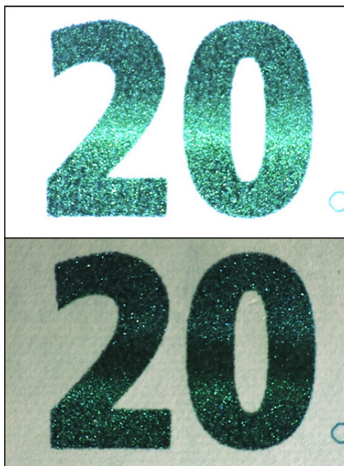
Ilustración 63: Detalle del valor facial en número en el margen inferior izquierdo del anverso del billete de 20 euros de la serie Europa, 2015. Tinta ópticamente variable, con efecto dinámico rolling bar y cambio de color verde-azul.
