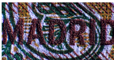
Ilustración 32: Detalle de la zona central del anverso en el que se observa el relieve de la impresión en calcografía de la palabra «MADRID».
