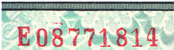
Ilustración 44: Detalle del margen inferior izquierdo del reverso del billete en el que observamos el número de serie impreso en tinta roja mediante técnica tipográfica. En la imagen se puede apreciar la falta de uniformidad de la impresión, provocada por la impronta de los tipos sobre el sustrato. Asimismo, también se puede percibir alguna mancha alrededor de la impresión.
