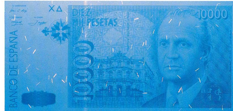
Fibrillas fluorescentes visibles a la luz ultravioleta Red and green fluorescent fibres visible to ultraviolet light Fibres fluorescentes rouges et vertes, visibles à la lumière ultraviolette
